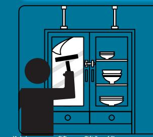
地震などで思わぬ力が加えられる事により、ガラス扉が破損してしまう場合があります。割れたガラスの破片でケガにつながる恐があるので、扉が開かないようロックをつけたり、飛散防止フィルムを貼って対策しましょう。
